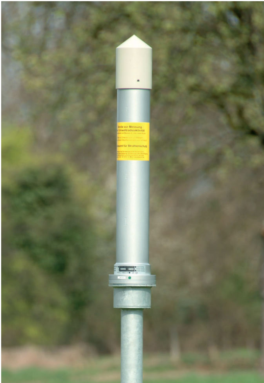
Messsonde einer ODL-Messstelle (Eigenentwicklung des BFS Typ GS07)
