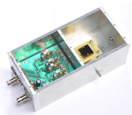
Prototyp einer CZT-Detektoreinheit (links) mit Ansteuer- und Auswerteelektronikmodul (rechts)
