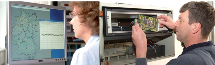
Rechnergestützte Aus- und Bewertung der Umweltradioaktivität im Messnetzknotten (links). Messwertsender mit Wandgehäuse (rechts)
