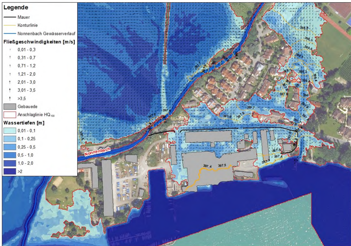
Abbildung 5-3 Wassertiefen und Fließgeschwindigkeiten im Untersuchungsbereich bei HQ 100 Nonnenbach und HQ 20 Bodensee aktualisierter Istzustand (Mauer Bodanstraße)
