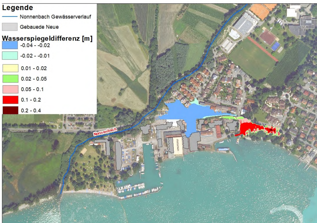
Abbildung 5-12 Differenz der Wasserspiegellagen zwischen Planzustand mit naB unter Berücksichtigung der Durchgängigkeit und aktualisiertem Istzustand (Nonnenbach HQ100 und Bodensee HQ20)
