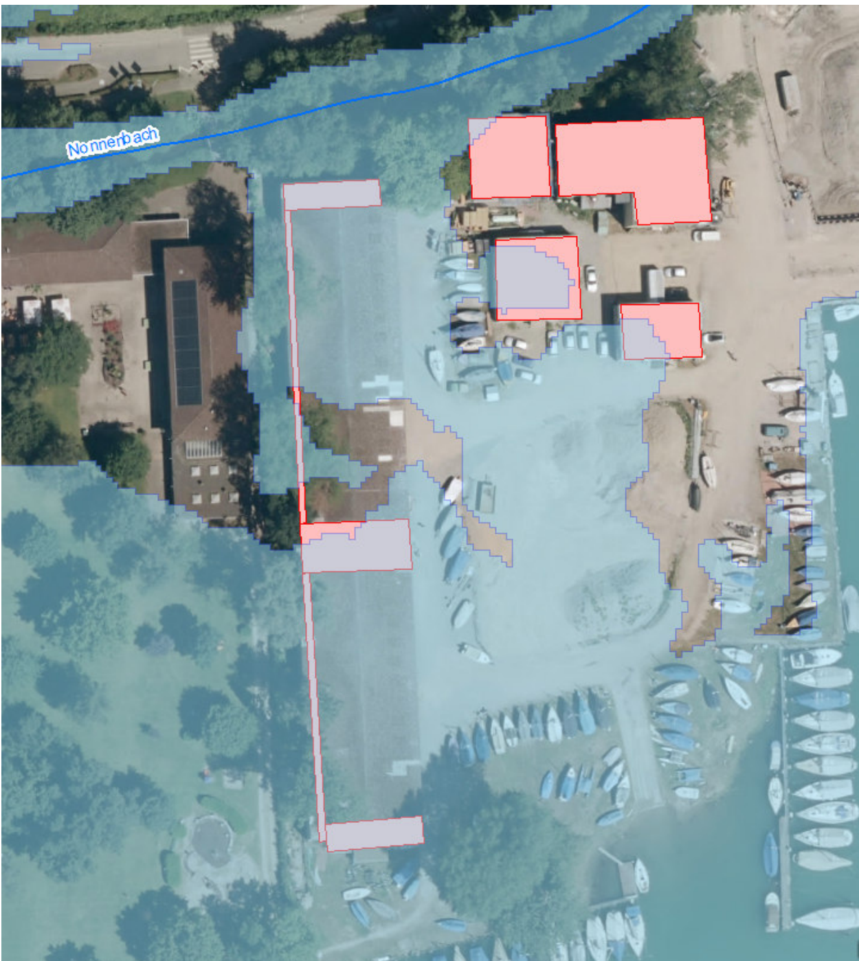
Abbildung 7-3: Gebäudeteile der Altbebauung, die als undurchströmbar bei der Bilanz berücksichtigt wurden Aus dem Verschnitt mit dem Wasserspiegel und der Annahme, dass noch ca. 20% der Lagerfläche der südlichen Halle derart in Anspruch genommen werden, wie in Abbildung 7-2 erkennbar, dann ergeben sich die in Tabelle 7-1 aufgeführten Werte.
