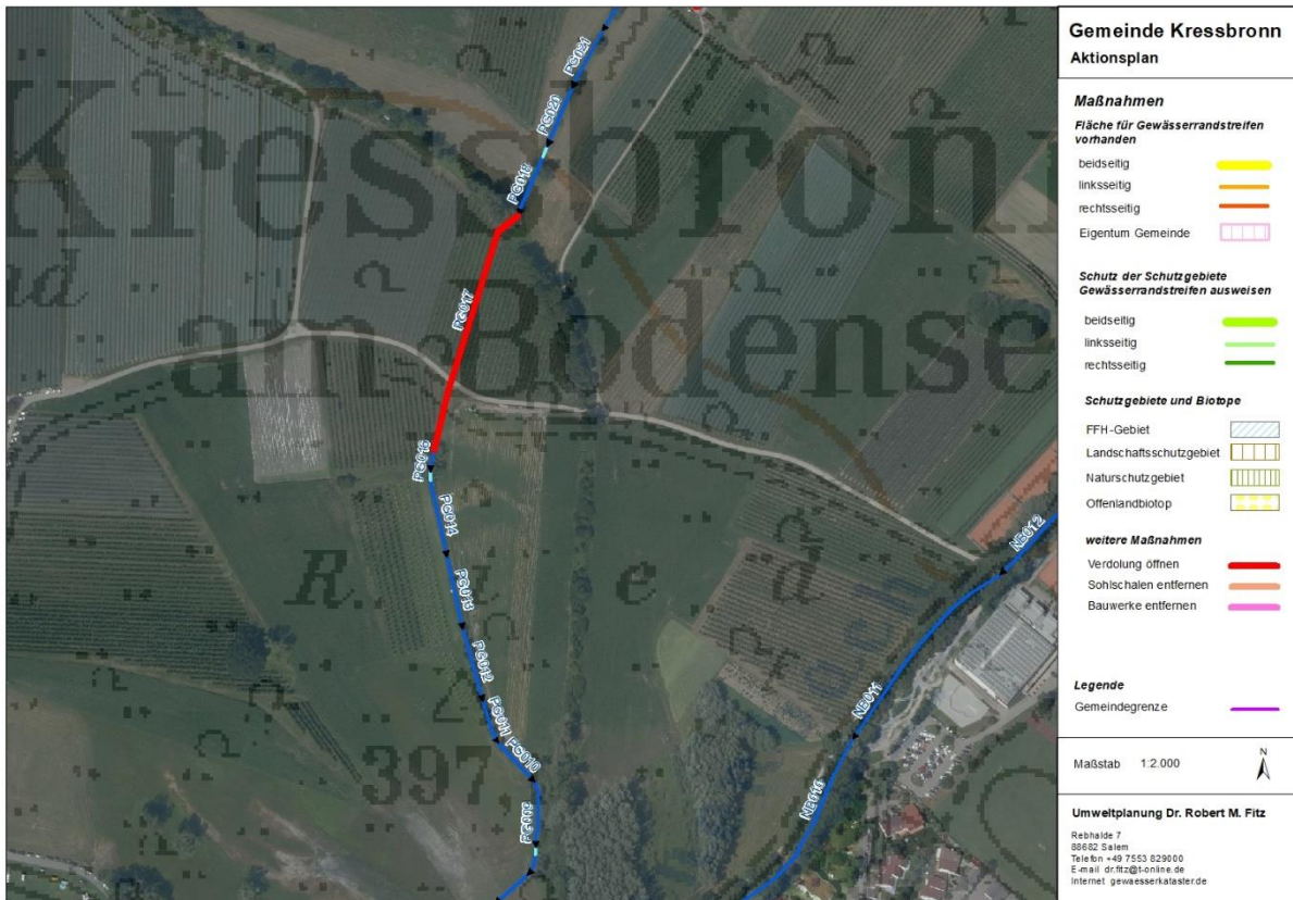
Abbildung 12: Öffnung langer Verdolungen und Renaturierung am Prozessgraben, PG017
