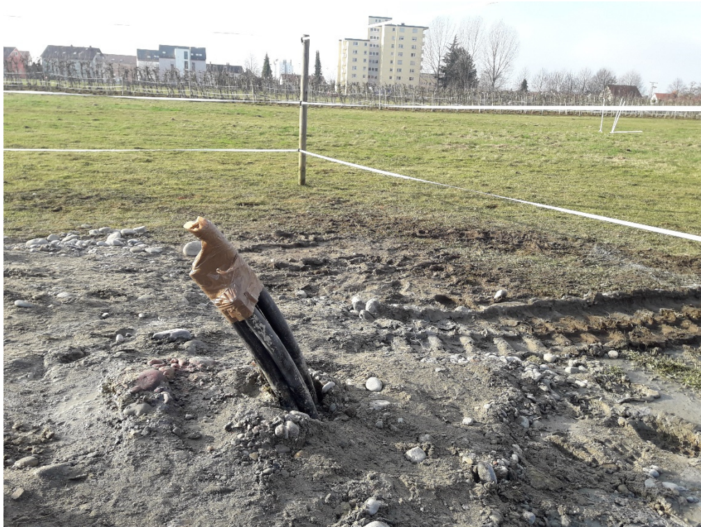
Abbildung 8: Erdwärmesonde nach Testende
