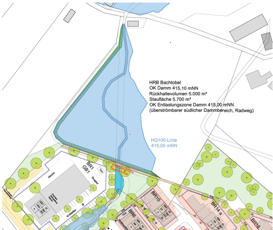
Abbildung 11: Lage des Hochwasserrückhaltebeckens Bachtobel
